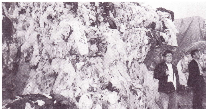
選別処理後プレスされた廃プラスチック
