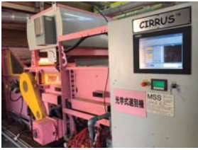
毎時2トンの処理能力 のある 光学式自動選別機
